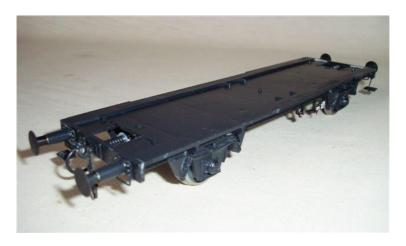
Die angespritzten Griffstangen in Kunststoff werden ans Gehäuse entfernt und durch 0.8 mm Draht ersetzt. An die Stirnseite wird noch ein Loch gebohrt (1.5 mm) mit darin einen Splint geklebt für die Stromzurüstung
