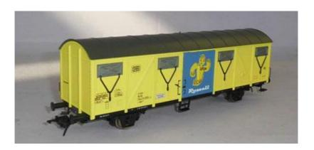
Ins Gehäuse kann etwa 200 gr. Ballast geklebt, oder eine Tischlerplatte von 16 mm Dicke, die genau auf den Wagenboden passt.
