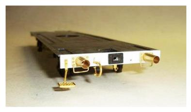
Weiter werden noch die Brems- und Lastschalter unter das Rahmen gebaut. Treppen werden auf die Seiten geklebt.
