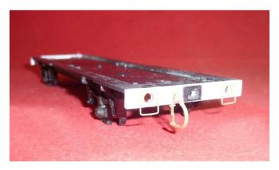
An die Unterseite werden Bremsdreiecken in 1 mm Draht geklebt, zwischen die Bremsklötze.
